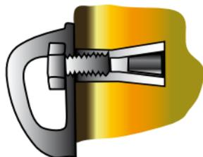
Le principe est l'enfoncement d'une cheville filetée sur laquelle, une fois frappée et verrouillée, on viendra visser une plaque d'assurage. L'expansion est assurée par un cône qui prend appui sur le fond du trou.
